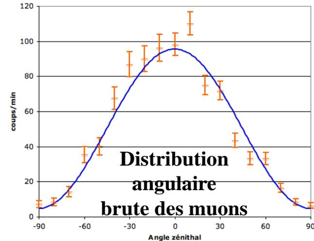
Figure 4 : Distribution zénithale des muons
