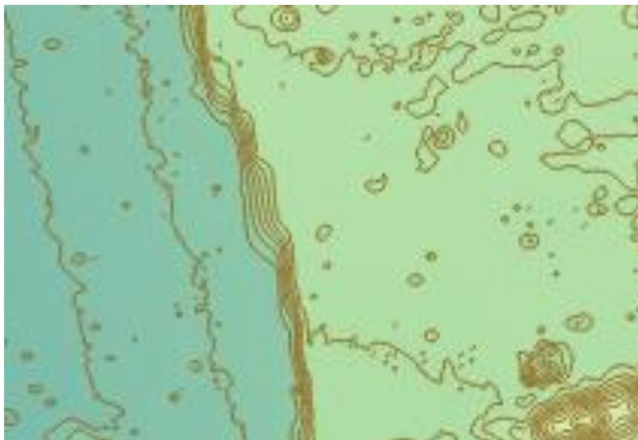
Avec ces courbes de niveau, nous trouvons une hauteur correspondant à 6 courbes de niveau soit 600 m pour le mur droit, ce qui nous a posé problème car c'est le double des résultats de nos recherches et premières mesures.
