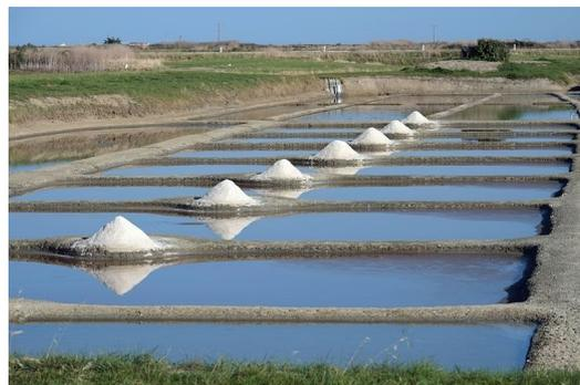
Figure 1: Marais salant dans lesquels le sel est cristallisé par l'évaporation de l'eau de mer saturée en sel
