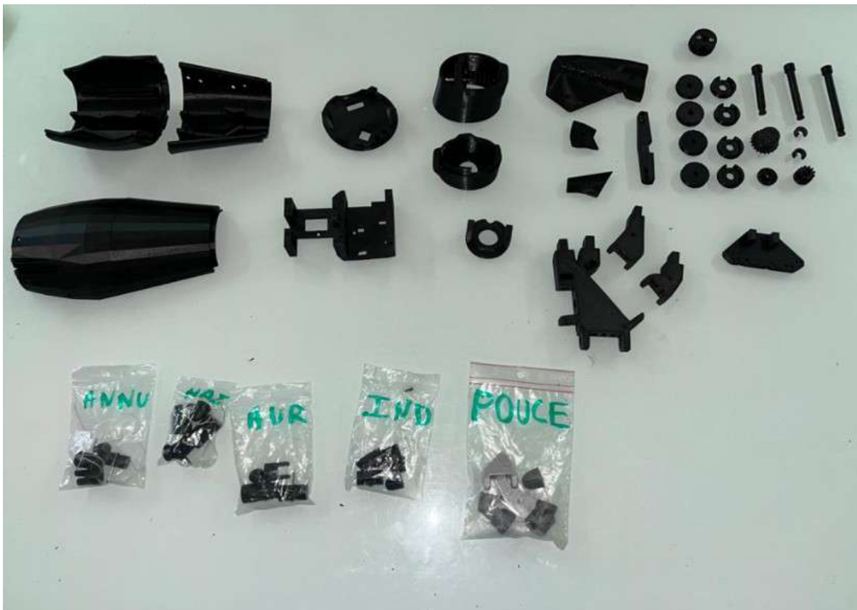
Figure 16 : Pièces en PLA de la prothèse
