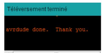
Si un message d'erreur apparaît, vérifier que le **Port** sélectionné correspond à celui du branchement de la carte. Menu : **Outil** → **Port**.
